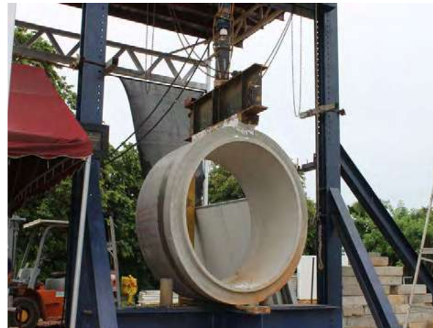
Ensayo a Compresión de Tuberías de Concreto
