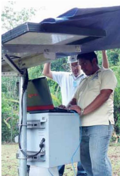
*Revista Extracción de la data del GPS instalado en Petro Terminales, Puerto Armuelles, la que es parte del proyecto de Deformación de la Corteza. El proyecto se desarrolla entre las Universidades de Panamá la Universidad Estatal de Pensilvania y UNAVCO.*
