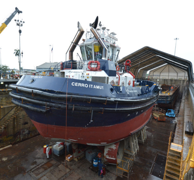
Reacondicionamiento mayor (carenado) de los equipos flotantes
