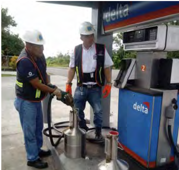
Verificación de surtidores y tanques de gasolina
