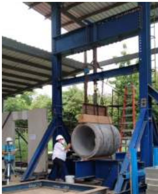
Ensayos a tubos de concretos realizados en el Laboratorio de Suelos y Ensayo de Materiales (LSEMA) del Centro Regional de Azuero.
