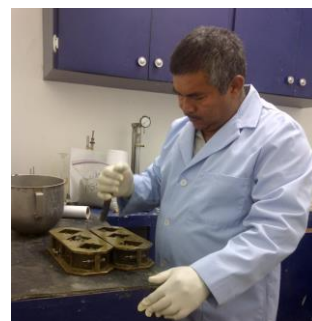
Ensayos de resistencia a la compresión del cemento gris
