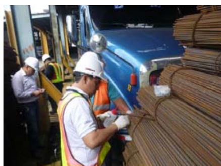
Toma de muestras de aceros para ensayos de corrosión
