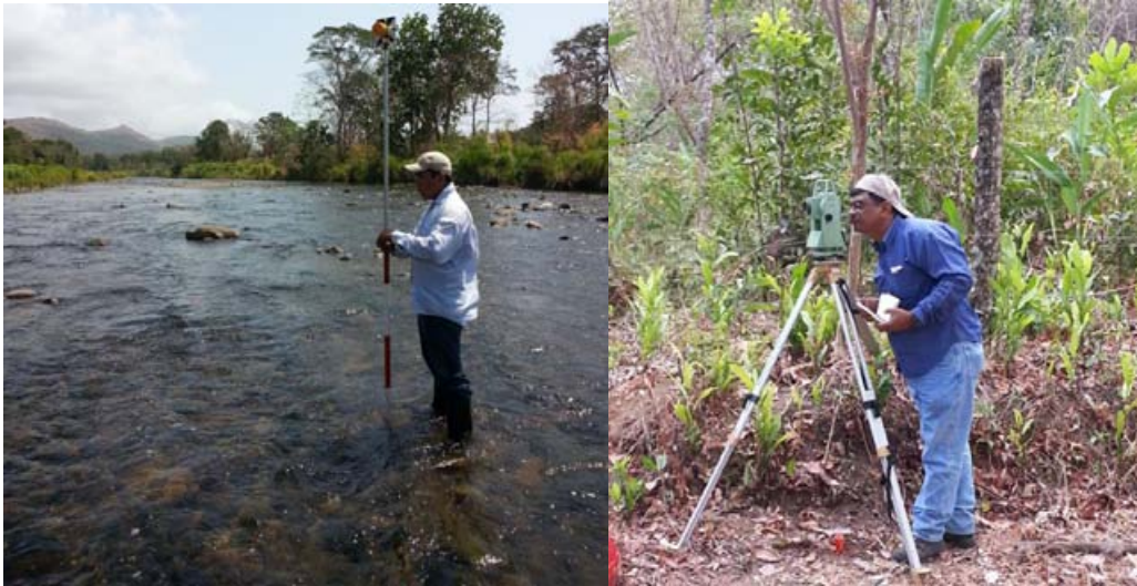
Levantamiento topográfico de secciones transversales del río Pacora
