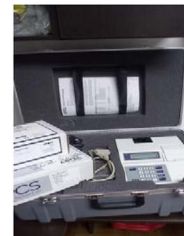
Maletín de transporte y reactivos para calibración de micropipetas.
