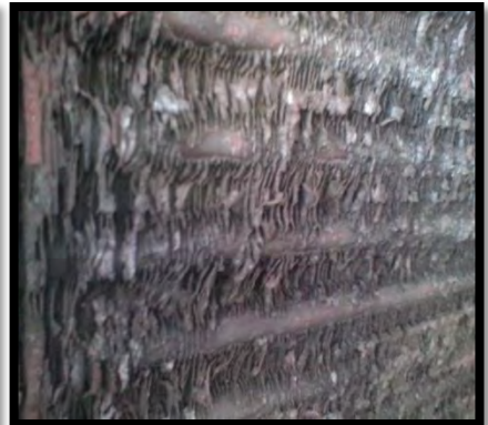
Hay que reemplazar la caja de filtro. MUY OXIDADO.
